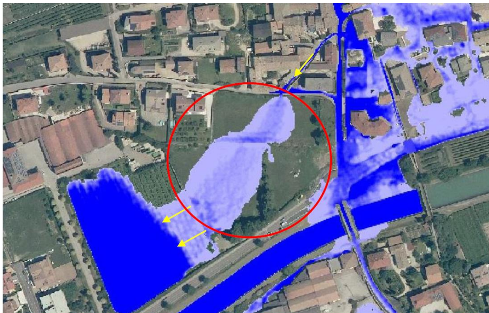
Figura 5.2: Risultati dell'analisi sviluppata da SBM – Scenario 2 con Tr = 200 anni.
